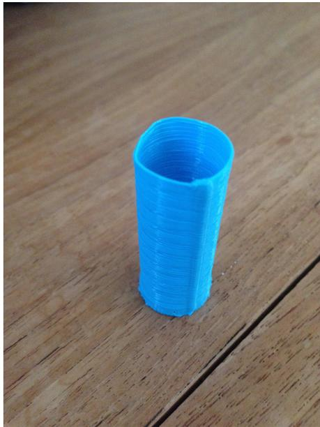
Abbildung 18: Zylinder nach Pickeloptimierung
